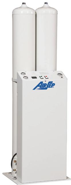
Los generadores de oxígeno de la serie Alpha de la marca AirSep producen entre 0,57 y 155,74 metros cúbicos (20 a 5500 pies cúbicos) de oxígeno por hora a una concentración de oxígeno de hasta el 95 %. Cuando se suministra electricidad y una fuente de aire comprimido, estos equipos confiables pueden proporcionar oxígeno para prácticamente cualquier aplicación.
