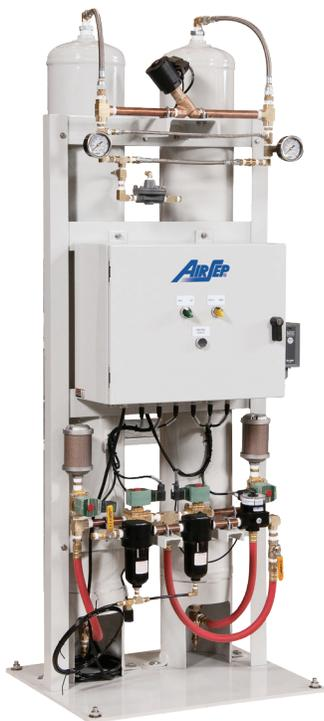
Los generadores de oxígeno de la serie Alpha de la marca AirSep producen entre 0,57 y 155,74 metros cúbicos (20 a 5500 pies cúbicos) de oxígeno por hora a una concentración de oxígeno de hasta el 95 %. Cuando se suministra electricidad y una fuente de aire comprimido, estos equipos confiables pueden proporcionar oxígeno para prácticamente cualquier aplicación.
