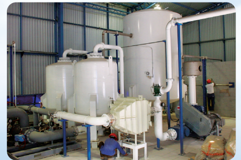
某钢铁厂的 ASV14500 VPSA 制氧装置 — 萨尔瓦多
