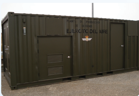
Installation d'oxygène PSA de haute pureté intégrée en conteneurs AS-J250-HPCR pour l'armée espagnole – Espagne
