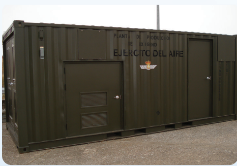
为西班牙军方提供的 AS-J250-HPCR 集装箱 式高纯度成套 PSA 制氧装置 — 西班牙
