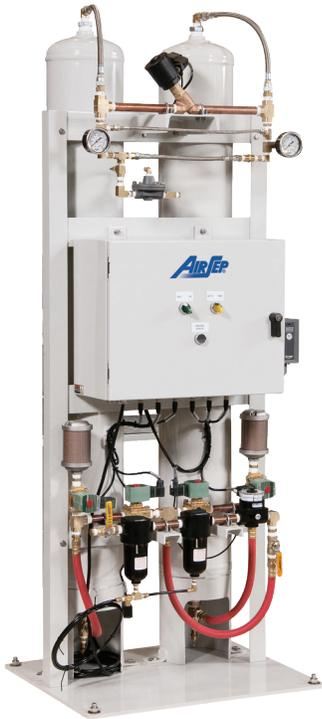
Les générateurs d'oxygène AirSep de série Alpha produisent de 0,56 m<sup>3</sup> à 156 m<sup>3</sup> (20 à 5 500 pieds cubes) d'oxygène par heure à une concentration en oxygène allant jusqu'à 95 %. Lorsque l'électricité et une source d'air comprimé sont fournies, ces machines fiables peuvent fournir de l'oxygène pour pratiquement toutes les applications.
