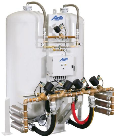
Les générateurs d'oxygène AirSep de série Alpha produisent de 0,56 m<sup>3</sup> à 156 m<sup>3</sup> (20 à 5 500 pieds cubes) d'oxygène par heure à une concentration en oxygène allant jusqu'à 95 %. Lorsque l'électricité et une source d'air comprimé sont fournies, ces machines fiables peuvent fournir de l'oxygène pour pratiquement toutes les applications.
