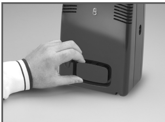
Figur 14: Aftagning af dækslet til luftindtagsfiltret
