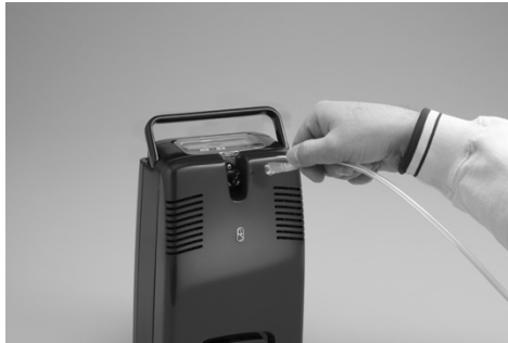
Figura 10: Conexión de la cánula a la salida de oxígeno del LifeStyle 5
