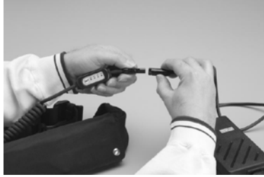
الشكل رقم 8: شحن بطارية حزام AirBelt
