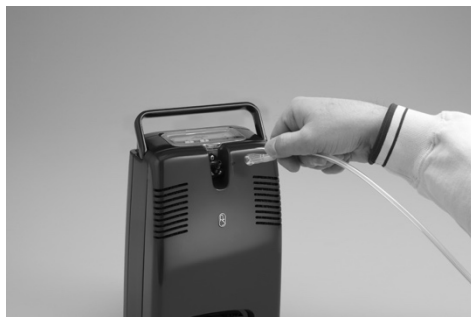
Figura 10: Collegamento della cannula al raccordo per l'ossigeno di FreeStyle 5
