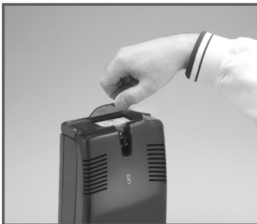
Figura 16: Como levantar a tampa de proteção contra poeira no visor do teclado
