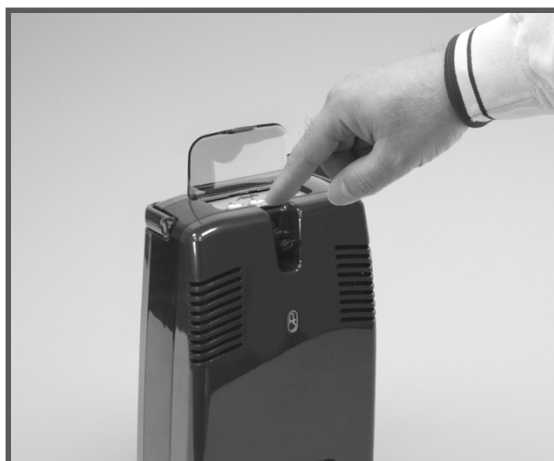
Figura 17: Modo de pressionar o botão de seleção do fluxo
