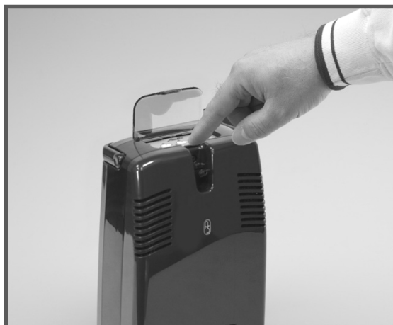
Εικόνα 17: Πάτημα κουμπιού επιλογής ροής
