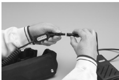
Figura 8: Ricarica della batteria dell'AirBelt
