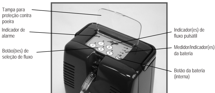
Figura 12: Detalhe do teclado/visor de alarme
