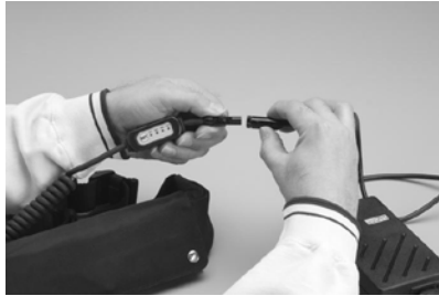
Figur 8: Opladningen af batteriet i AirBelt
