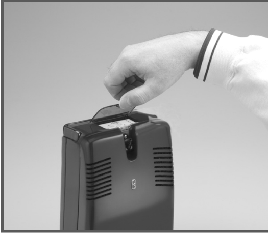
Abb. 16: Staubschutz über Bedienfläche öffnen
