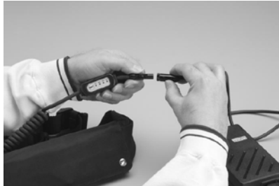
Figure 8 : Recharge de la batterie Airbelt
