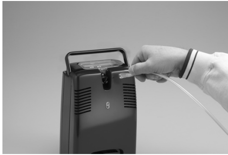
Abb. 10: Verbinden der Kanüle mit der Sauerstoffaustrittsöffnung des FreeStyle 5-Geräts
