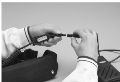
Εικόνα 8: Φόρτιση της μπαταρίας AirBelt
