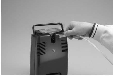
الشكل رقم 10: توصيل الفُتَيَّة بمخرج الأوكسجين الحر في وحدة FreeStyle 5
