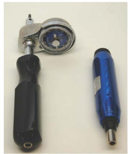
Abbildung 8.1c 0-50 lb-Drehmomentschraubendreher oder 15 lb-Schraubendreher (festes Drehmoment)
