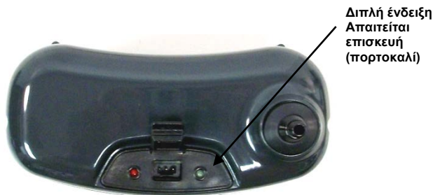
Εικόνα 22: Ένδειξη απαιτούμενου ελέγχου/επισκευής
