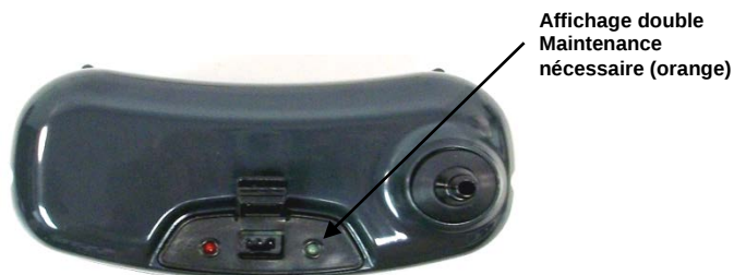
Figure 22 : Indicateur d'inspection/maintenance nécessaire
