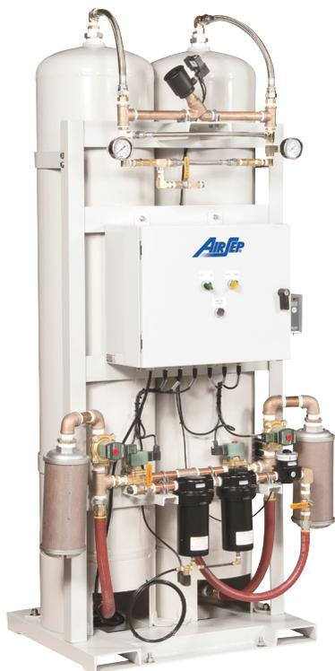
Los generadores de oxígeno de la serie Alpha de la marca AirSep producen entre 0,57 y 155,74 metros cúbicos (20 a 5500 pies cúbicos) de oxígeno por hora a una concentración de oxígeno de hasta el 95 %. Cuando se suministra electricidad y una fuente de aire comprimido, estos equipos confiables pueden proporcionar oxígeno para prácticamente cualquier aplicación.
