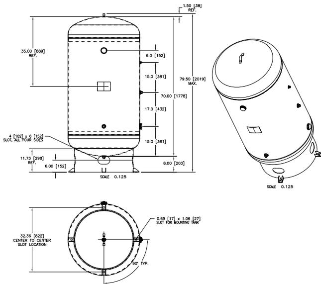
Receptor de 719,23 litros (290 galones) para el generador modelo AS-K a AS-L (con flujos que superan los 31,52 Nm<sup>3</sup>/h [1199 SCFH])
