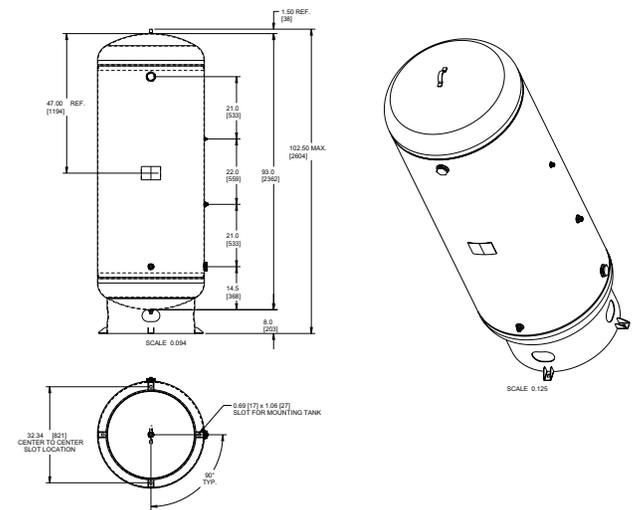
Receptor de 1514,16 litros (400 galones) para el generador modelo AS-L (con flujos que superan los 31,52 Nm<sup>3</sup>/h [1199 SCFH])
