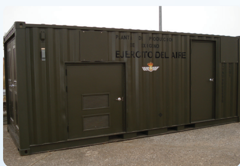
Instalação de oxigênio PSA integrada de alta pureza contentorizada AS-J250-HPCR para o Exército de Espanha – Espanha
