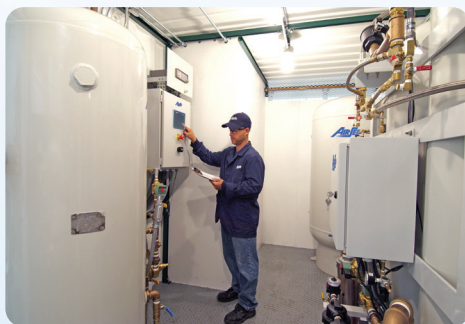
Instalação de oxigênio PSA integrada de alta pureza contentorizada AS-J250-HPCR para as forças da NATO – Afeganistão
