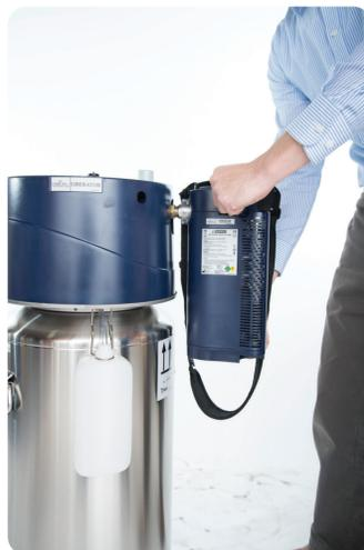
Sobald sich das Füllgeräusch verändert und es aus der Abdeckhaube der Standeinheit zu "dampfen" beginnt, ist das Mobilsystem voll. Schließen Sie nun das Entlüftungsventil in die Ausgangsposition.
