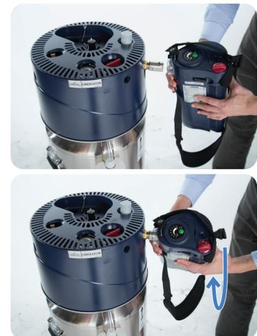
Schließen Sie den Durchflussregler. Positionieren Sie die Mobileinheit in einem etwa 45° Winkel neben dem seitlichen Füllstutzen der Standeinheit. Die Einkerbung am Füllstutzen der Standeinheit muss mit dem Metallstift am Füllstutzen des Mobilsystems übereinstimmen.
