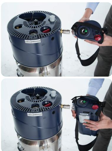
Sollte das Mobilsystem während des Füllvorgangs festfrieren, schließen Sie das Entlüftungsventil und lassen das Mobilsystem auf dem Füllstutzen stecken. Sobald die Füllstutzen abgetaut sind, kann das Mobilsystem einfach entnommen werden.
