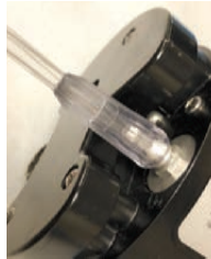
Hình 4-2. Lắp ống thông
