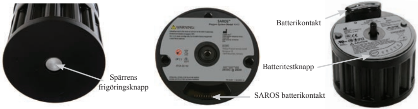
Bild 3-1. Montering av batteri
