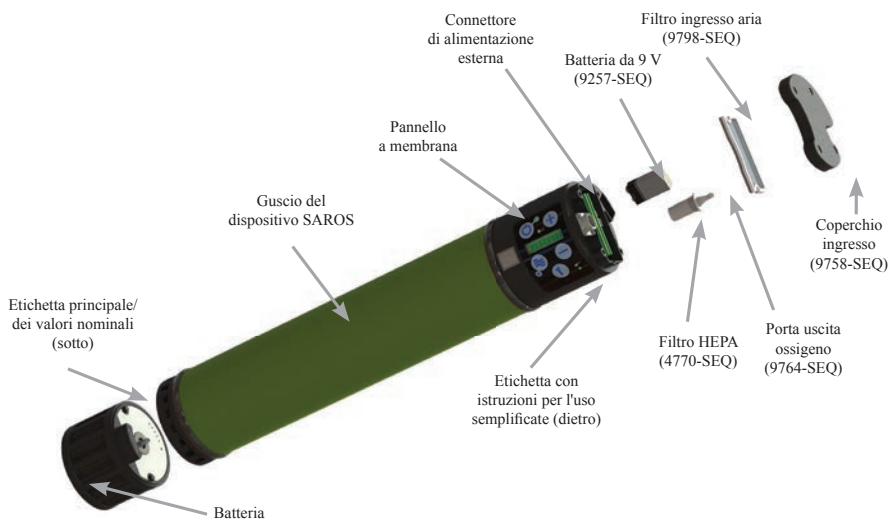
Figura 2-1. Componenti del dispositivo SAROS
