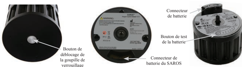
Figure 3-1. Installation de la batterie
