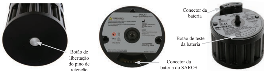
Figura 3-1. Instalação da bateria
