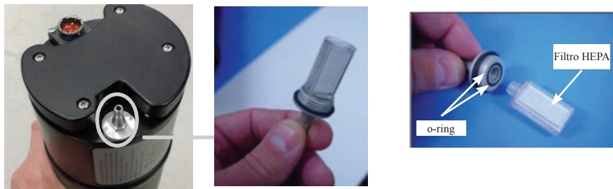
Figura 5-4. Reinstallazione del raccordo O2/filtro HEPA
