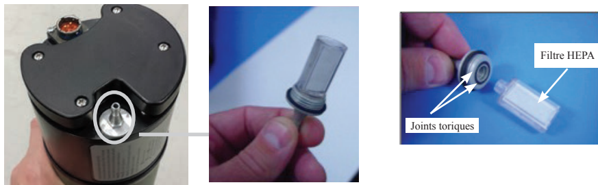
Figure 5-4. Réinstallation du raccord O2/filtre HEPA
