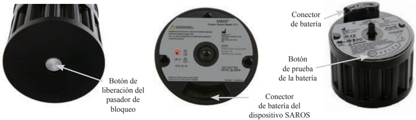
Figura 3-1. Instalación de la batería
