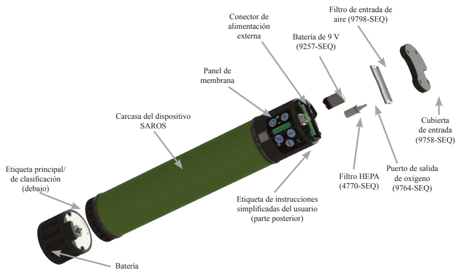
Figura 2-1. Componentes del dispositivo SAROS
