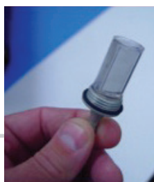
Abbildung 5-4. O2-Anschluss/HEPA-Filter wieder einbauen
