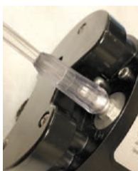
Figura 4-2. Installazione della cannula
