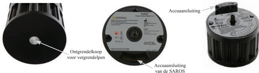
Afbeelding 5-1. Plaatsing van de accu
