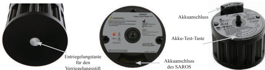
Abbildung 3-1. Einlegen des Akkus
