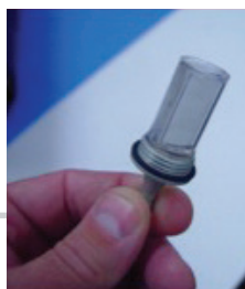
Figure 5-4. Réinstallation du raccord O2/filtre HEPA
