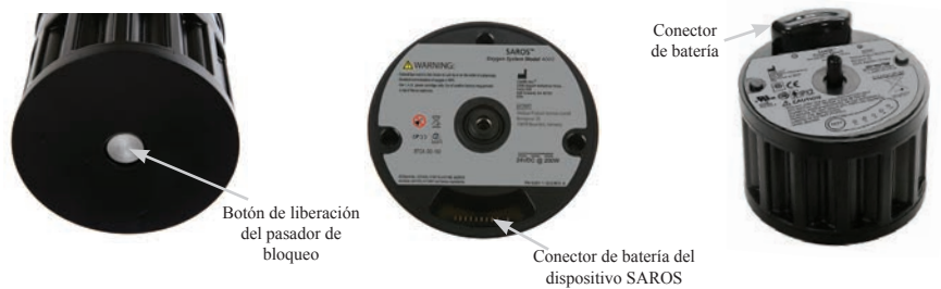
Figura 5-1. Instalación de la batería
