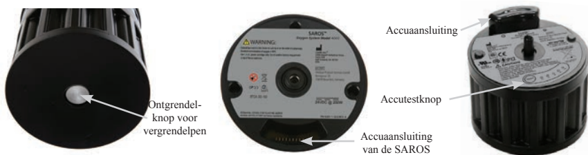
Afbeelding 3-1. Plaatsing van de accu
