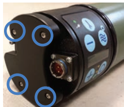
Afbeelding 5-2. De kap verwijderen
