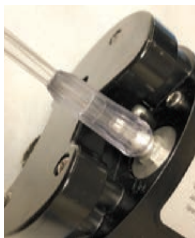
Abbildung 4-2. Einbau der Kanüle
