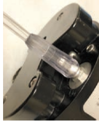
Figura 4-2. Instalación de la cánula
