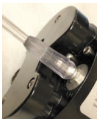
Bild 4-2. Montering av kanyl
