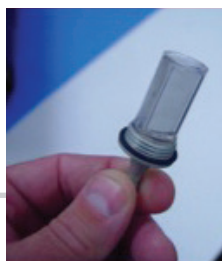
Figura 5-4. Reinstale o encaixe de O2/Filtro HEPA
