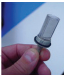
Kuva 5-4. Asenna O2-liitin/HEPA-suodatin uudelleen
