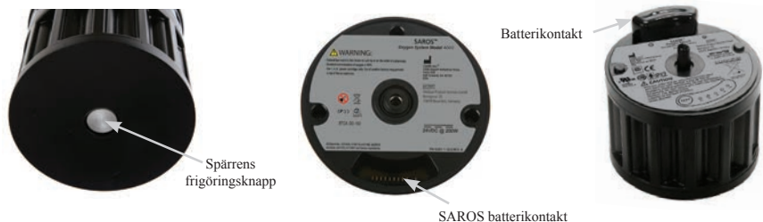
Bild 5-1. Montering av batteri
